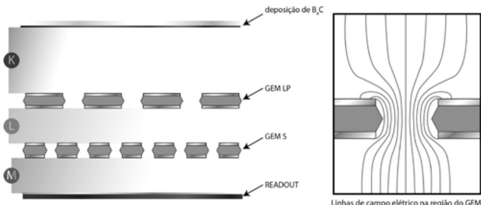
Na parte superior da região J foi depositada uma camada de  $^{10}\text{B}_4\text{C}$  que atua como conversor, sendo que o nêutron é detectado de modo indireto, no qual produtos da reação  $\text{n} + ^{10}\text{B} \rightarrow ^7\text{Li}$
