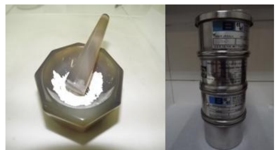
Figura 2: Ágata e peneiras utilizadas na moagem do cristal e seleção granulométrica.
