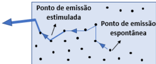
Figura 1: Ilustração de um fóton emitido espontaneamente e amplificado devido aos múltiplos espalhamentos sofridos
