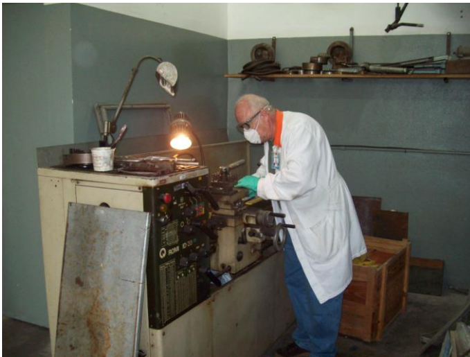
Figura 55. Dr. Reynaldo usinando um dos filtros de Bismuto no Torno Mecânico para a retirada de 0,5mm de espessura do objeto.
