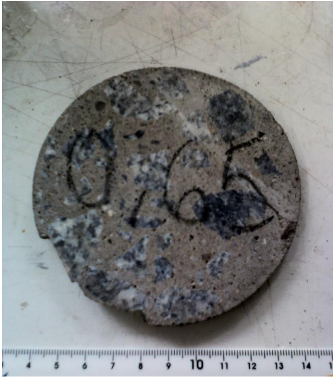
Figura 53. Amostra de concreto utilizado para ensaio de análise de fissuras e descontinuidades por radiografia com nêutrons.
