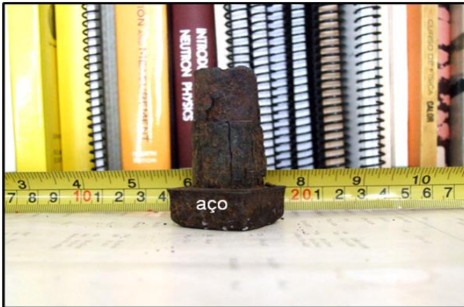
Figura 49. Parafuso com ferrugem tomografado.
